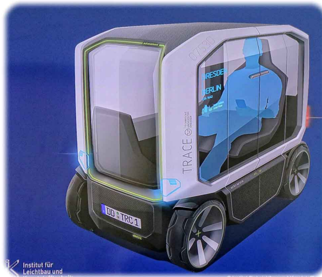
Wird „Trace“ verwirklicht, kaufen sich die Menschen Kabinen statt Autos und bestellen dann nur je nach Reisezweck passende fahrbare Untergestelle, die sie autonom von A nach B bringen. Abb.: ILK der TUD, Repro: hw
